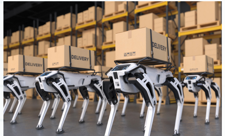
Mobilni roboti, kot je robot pes, so zaradi svoje stabilnosti in prilagodljivosti posebej zanimivi za industrijska okolja, kjer lahko pomagajo pri pregledih, nadzoru in preprostih logističnih nalogah
