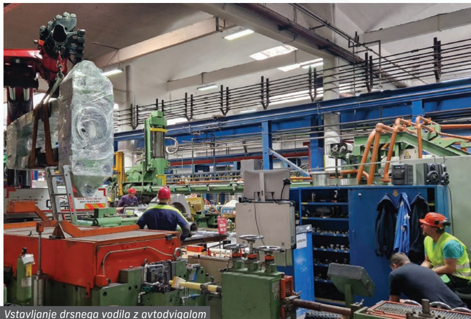
Vstavljanje drsnega vodila z avtodvigalom
