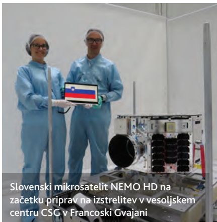
NEMO HD na SSMS strukturi tik pred zapiranjem pod pokrov rakete
