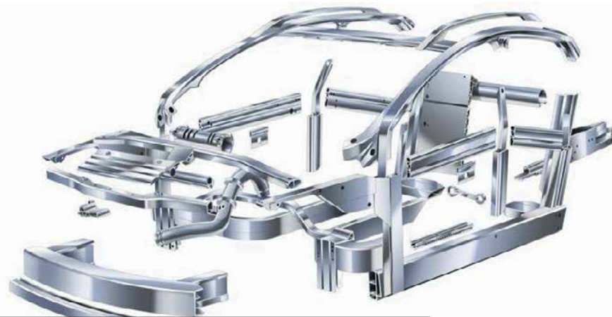
Možni aluminijasti iztiskani deli v avtomobilih (crash in non-crash)
