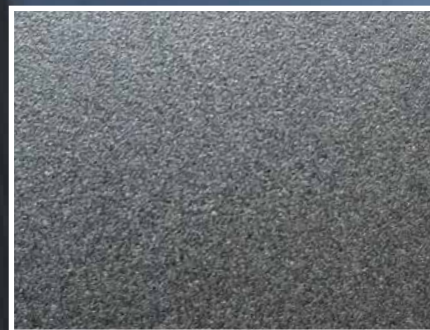
Slika: Izgled površine a uminijskega traku EDT
