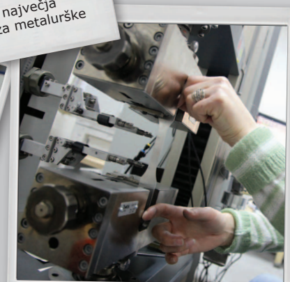
Vpenjanje preizkušanca na trgalnem stroju Zwick 10 kN
